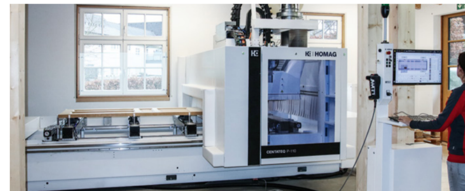
Esther Jürgens-Steinberg programmiert die kompakte „Slim“-Version, für die auch 5-Achsbearbeitung ohne Einschränkung möglich ist.
