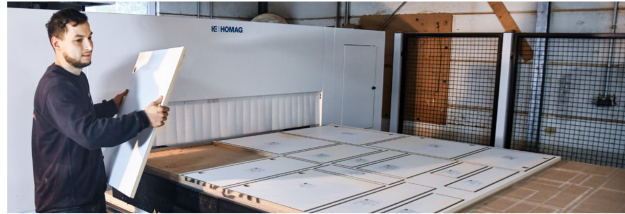
Mit der dreischigen CENTATEQ N-210 nestet die Prima Systeme GmbH in einem Schritt zahlreiche Bauteile mit unterschiedlichen Maßen und Bohrungen in Kommission.
