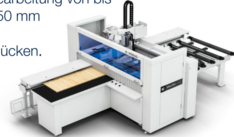
Unterstützt durch ihren 4-fach-Werkzeugwechsler mit HSK-Schnittstelle bietet sie direkt zum Start schon eine hohe Flexibilität für die Bearbeitung.
